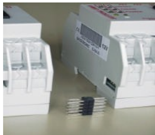
Простое и надежное соединение измерительно-управляющих модулей при помощи специального разъема
