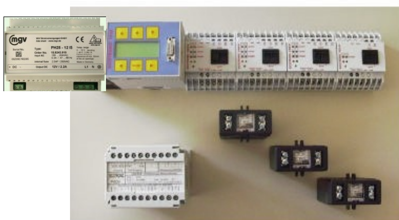
Сикотроник 1010 с модулями АВМ, 4-мя измерительно-управляющими модулями, измерителем активной мощности и блоком питания SVEBUS
